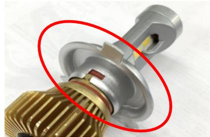
5) バルブから取り外した金具、ノーマルの押さえ金具、ノーマルゴムキャップの順番でヘッドライトケースに取り付けます。
