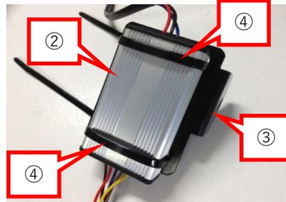
1) まず最初に「②ドライバー」を「③ドライバー用ステー」に「④タイラップ」を使用ししっかりと取り付けます。
