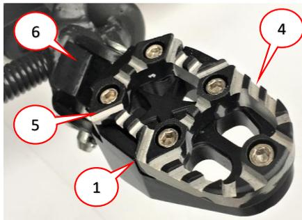
取り外したノーマルピン・割ピンと「⑤カラー」を下図の位置に使用して、フットペグを取り付けます。
